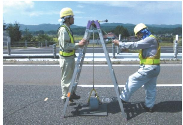
写真-1 衝撃振動試験測定状況
