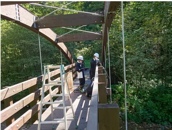
図2 めおと橋の材料特性（ヤング率）の調査
