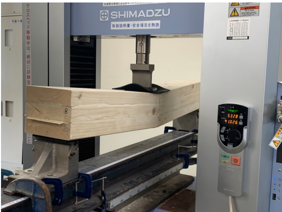
図3 アラミド挿入ハイブリッド木梁の破壊試験
