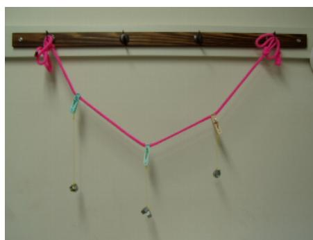
さて、今、ひもの両端を固定して、ひもの適当なところに、重りをいくつかぶらさせてみる。そうすると、ひものは折れ線になってつりあう。このとき、（ひもの張力しか作用していないので）ひものは、重りを張力だけで支えていることになる。
