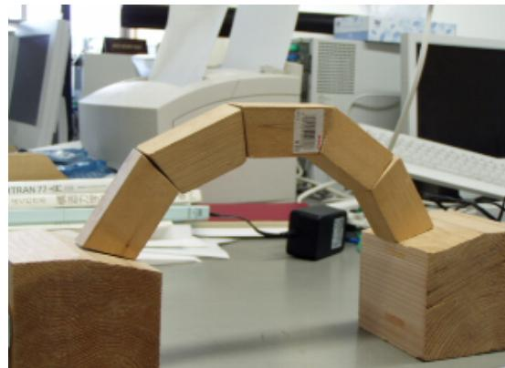
曲げられることに弱い材料でも、棒状にして（三角形を組み合わせた）骨組みにしてやると曲げられる力があまり作用しなくなる。主に圧縮される力が作用している棒と、引っ張られる力が作用している棒がある。
