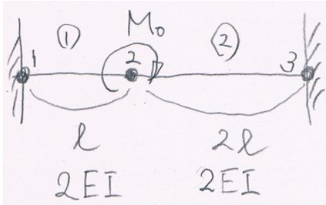
長さ  $l$ , 曲げ剛性  $2EI$  の梁要素① と長さ  $2l$ , 曲げ剛性  $2EI$  の梁要素②が、図のように連結され (各節点は剛結)、両端は固定され、節点 2 に右回りのモーメント外力  $M_0$  が作用している。梁の剛性方程式を用いて、節点 2 の節点変位  $v_2, \theta_2$  と各節点の内力としての節点力  $S_1, M_1, S_2^{\text{①}}, M_2^{\text{①}}, S_2^{\text{②}}, M_2^{\text{②}}, S_3, M_3$  を求めよ。
