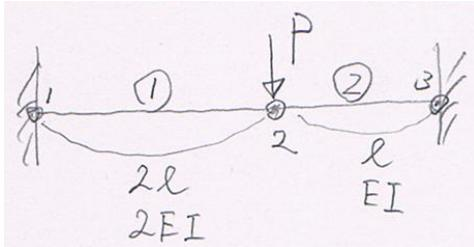
長さ  $2l$ , 曲げ剛性  $2EI$  の梁要素①と長さ  $l$ , 曲げ剛性  $EI$  の梁要素②が、図のように連結され (各節点は剛結)、両端は固定され、節点 2 に鉛直荷重  $P$  が作用している。梁の剛性方程式を用いて、節点 2 の節点変位  $v_2, \theta_2$  と各節点の内力としての節点力  $S_1, M_1, S_2^{\text{①}}, M_2^{\text{①}}, S_2^{\text{②}}, M_2^{\text{②}}, S_3, M_3$  を求めよ。
