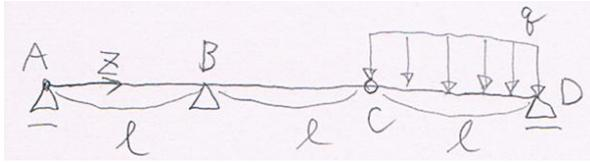
図のようなゲルバー梁の  $S$  図 (上が正),  $M$  図 (下が正) を描け。せん断力  $S(z)$ , 曲げモーメント  $M(z)$  は求めなくてもよい。
