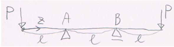
せん断力  $S(z)$ , 曲げモーメント  $M(z)$  を求め、 $S$  図 (上が正),  $M$  図 (下が正) を描け。
