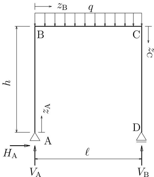
問 2: 図のような等分布荷重を受ける静定ラーメンについて、AB, BC, CD 区間の軸力  $N(z_A), N(z_B), N(z_C)$ , せん断力  $S(z_A), S(z_B), S(z_C)$ , 曲げモーメント  $M(z_A), M(z_B), M(z_C)$  を求め、軸力図 (外側が正)、せん断力図 (外側が正)、曲げモーメント図 (内側が正) を図示せよ。図中にはピークの値を (適宜、 $q$  や  $l$  等の記号を用いて) 記入し、つりあいを求めるために作図した切断図や計算過程なども余白に書ける限り書き残すこと。
