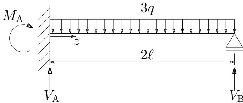
図の不静定梁のたわみを求めよ。曲げ剛性は  $EI$  とする。
