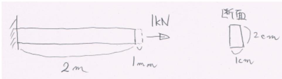
図のような左端を固定された長さ 2m の棒が、右端を 1kN で引っ張られ、右端が 1mm 伸びた。この棒の断面は 1cm×2cm の長方形である。この棒のばね定数、軸方向の直応力、軸方向の直ひずみ、ヤング率を解答欄に指定された単位で答えよ。
