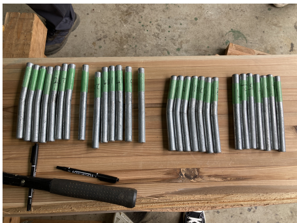
図-7 破壊後のドリフトピン
