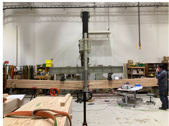
図-5 破壊後の試験体 1
