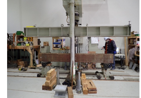
図-4 3 点曲げ試験（製材）
