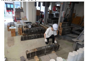
図-6 応力波伝播速度試験
