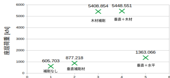
図-7 座屈結果 モデル 2
