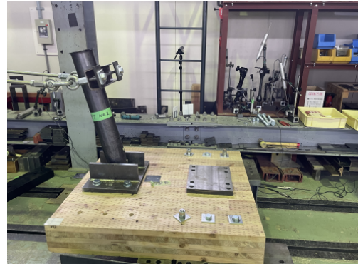
図-1 静荷重試験
