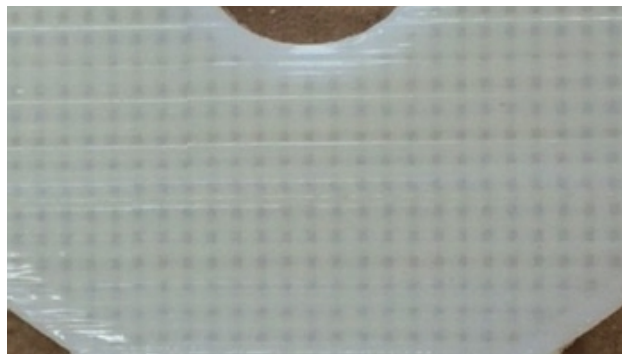
図-2 吊り下げ部の格子状構造
