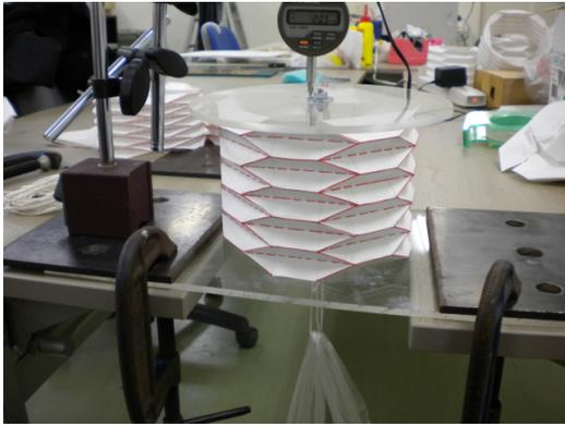
写真-2 円筒折り紙構造の圧縮試験
