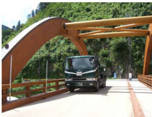
写真-3 静的荷重試験
