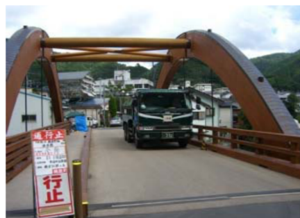
写真-5 試験車両走行試験
