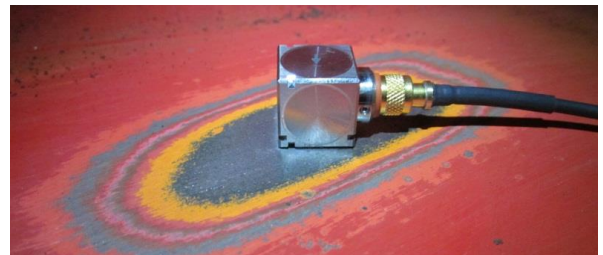
(b) 圧電素子型の加速度センサー
