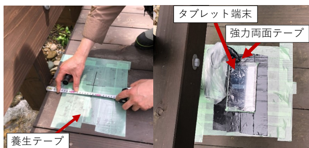
図-4 タブレット端末加速度計の設置の様子
