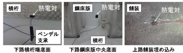
写真-1 熱電対設置状態
