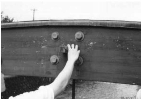
写真1 電気抵抗式含水率計
