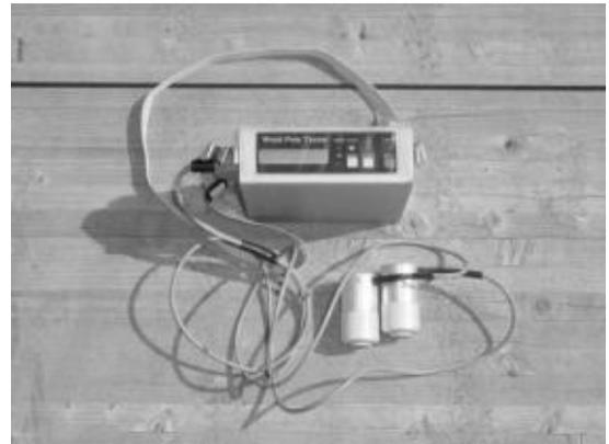
写真3 超音波伝播速度測定
