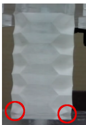
図-21 破壊直前の試験体
