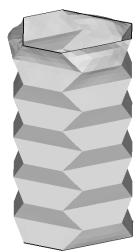
図-21 破壊直前の試験体
