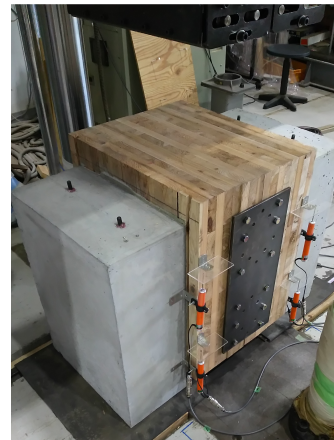
図-1 押し抜き試験の試験体
