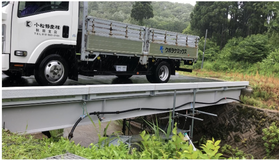
西仙北 車両載荷実験の様子
