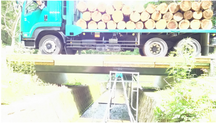
田沢湖 車両載荷実験の様子
