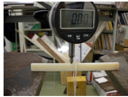
図-2 曲げ試験体
