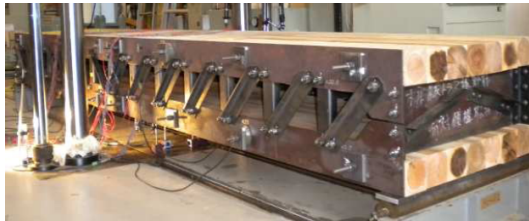
角形鋼管と鋼板挿入集成材梁を用いたハイブリッド木橋
