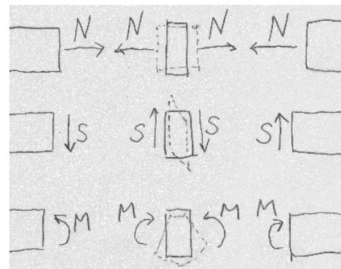
構造力学で使われる断面力の正の向きは座標の正の向きではないので、注意が必要である。切断面における作用・反作用の関係が分かりやすいように、左側の切断面と右側の切断面とでは正の向きを逆に定義している。このように定義した方が、「向きは同じだけど符号が逆」と定義されるよりも視覚的には考えやすい。但し、コンピューターで大量の変位自由度を扱うマトリクス法などの有限要素解析の「節点力」においては、力の向きと座標の向きが一致していた方が便利なので、「向きは同じだけど符号が逆」の扱いになる。
