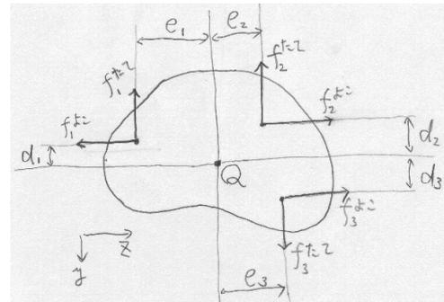
$$\text{点 } Q \text{ 回りのモーメントの合計: } M = -f_1^{t\tau} e_1 + f_1^{y\tau} d_1 + f_2^{t\tau} e_2 - f_2^{y\tau} d_2 - f_3^{t\tau} e_3 + f_3^{y\tau} d_3$$
