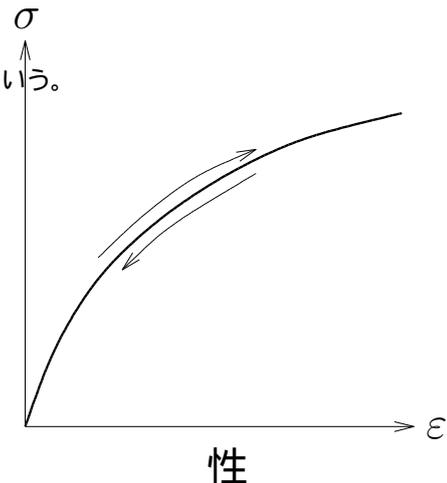
比例関係というのは、グラフに書くと直線になるので線形というが、ちなみに、弾性だからといって線形だとは限らないし (力を取り除くと元に戻るけど、力と変形の関係は線形じゃない非線形弾性もあるし)、線形だからといって弾性だとは限らない (力と変形の関係は線形だけど力を取り除いても元に戻らない線形非弾性もあり得る) ので混同しないように。
