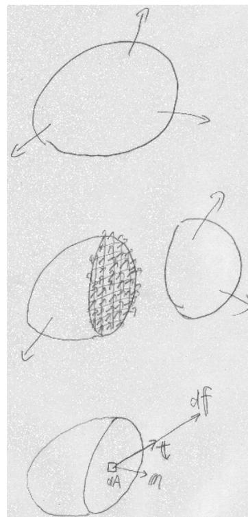
そこで、切断面のある微小部分にだけ着目し、面積  $dA$  の微小部分に作用する内力を、(この微小範囲の内力の分布に関してはまとめてしまってもいいことにして) 1 つの力  $df$  にまとめて表す。この  $df$  を微小部分の面積  $dA$  で割って圧力の次元で表した  $t = \frac{df}{dA}$  を表面力ベクトルという。  $t$  は、微小部分の内力を 1 つにまとめたものだから、力の
