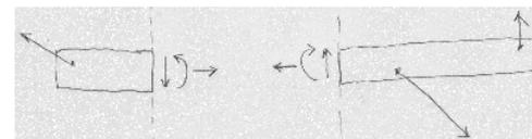
軸力: 切断面に垂直な(軸方向の)1つの力
